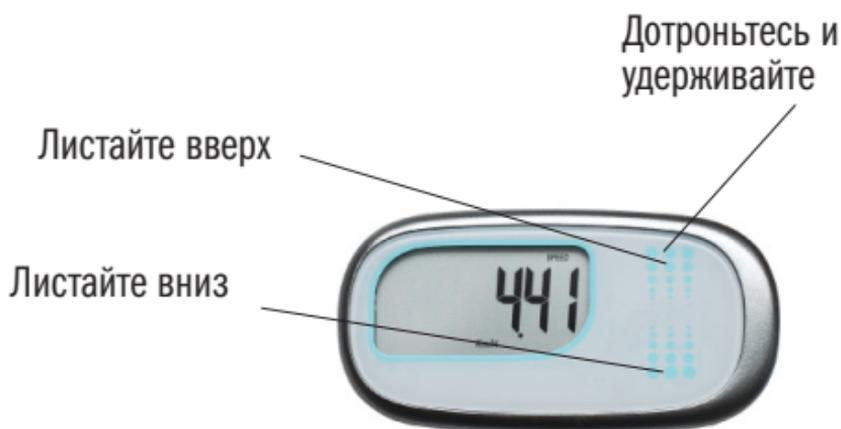
Функции шагомера находятся в следующей последовательности: Часы, Количество пройденных шагов, Пройденное расстояние, Затраченные калории, Скорость ходьбы, Время, затраченное на ходьбу, Память.
