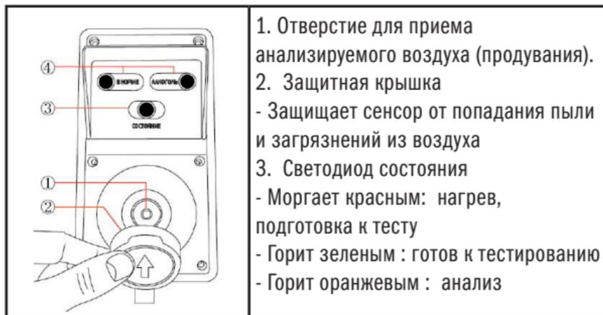
1. Отверстие для приема анализируемого воздуха (продувания).
