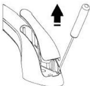
Используя плоскую отвертку, вставьте ее в отверстие между крышкой и корпусом поручня, надавите вниз и снимите крышку. Повторите процедуру с другого конца.
