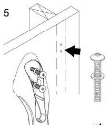
Зафиксируйте поручень с помощью болтов и шайб на стене.
