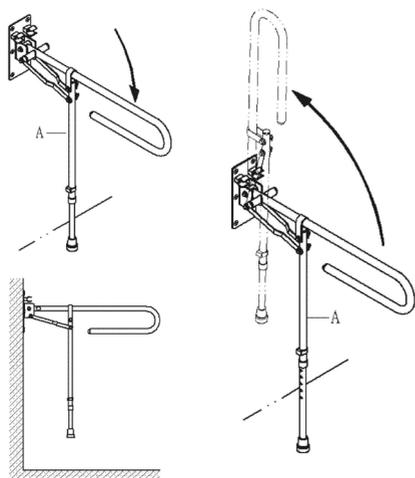
3. Для использования поручня опустите его. Чтобы сложить поручень, поднимите его вверх к стене.
