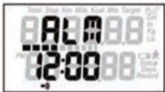
Подержите кнопку “Set” (установка) в течение 2-х секунд, пока на дисплее не замигают цифры будильника. Замигают часы.
