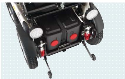
• Амортизаторы, отсек для аккумуляторов передних колес
