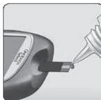
Прикоснитесь этой висячей каплей контрольного раствора к капилляру на **верхнем срезе** тест-полоски. Контрольное поле должно полностью заполниться раствором. Не наносите контрольный раствор на гладкую поверхность тест-полоски.
