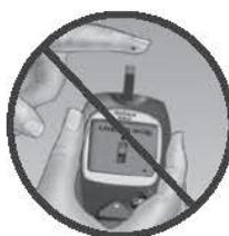
Не держите глюкометр и тест-полоску ниже капли крови. Кровь может попасть в зону ввода тест-полоски и повредить прибор.
