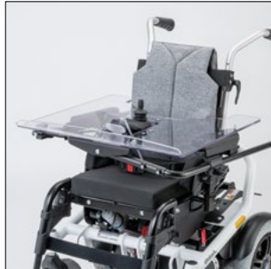
EU 06 Пульт управления интегрированный в столик
