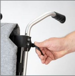
ED 10 Ручки для сопровождающего лица с регулировкой по высоте, быстросъемные
