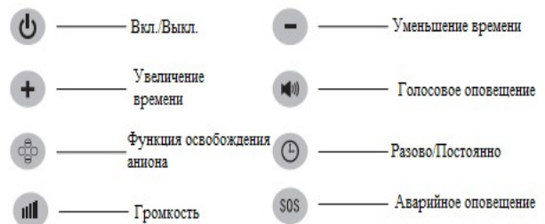
Рис.7. Схема пульта дистанционного управления
