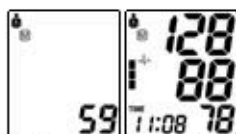
ДМСР-1R: Значок «4» обозначает нарушение
