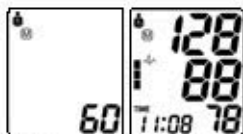
ДМСР-1: Значок «4» обозначает нарушение
