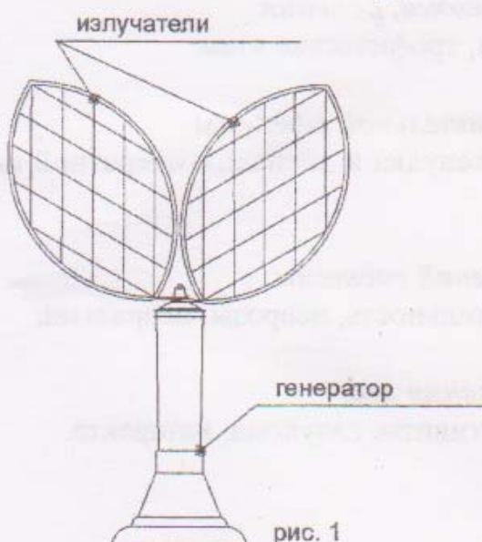
Извлеките генератор и излучатели из упаковки. Установите излучатели на центральный винт генератора и закрепите их фигурной гайкой. Вид собранного ионизатора показан на рисунке 1.
