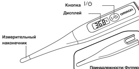
Благодарим Вас за приобретение цифрового термометра OMRON Flex Temp Smart.
