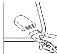
**Присоединяйте выключатель только после полного высыхания матраца и штепсельного соединения.**
