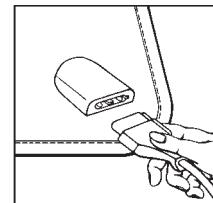
**Enchufe usted el interruptor a la colchoneta de calentamiento solamente después que la colchoneta y el enchufe estén completamente secos.**
