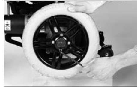
Рис. 48 Демонтаж приводного колеса
