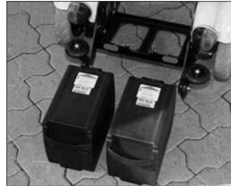
Рис. 4 Извлеченные блоки аккумуляторов
