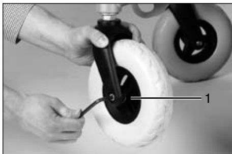
Рис. 49 Демонтаж переднего колеса
