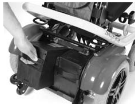
Рис. 11 Снятие блока аккумулятора
