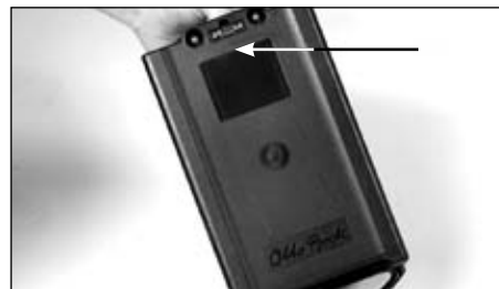
Рис. 47 Блок аккумуляторов с предохранителем
