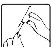
3. Поместите ватный тампон в трубку, а затем вкрутите её в крышку увлажнителя.
